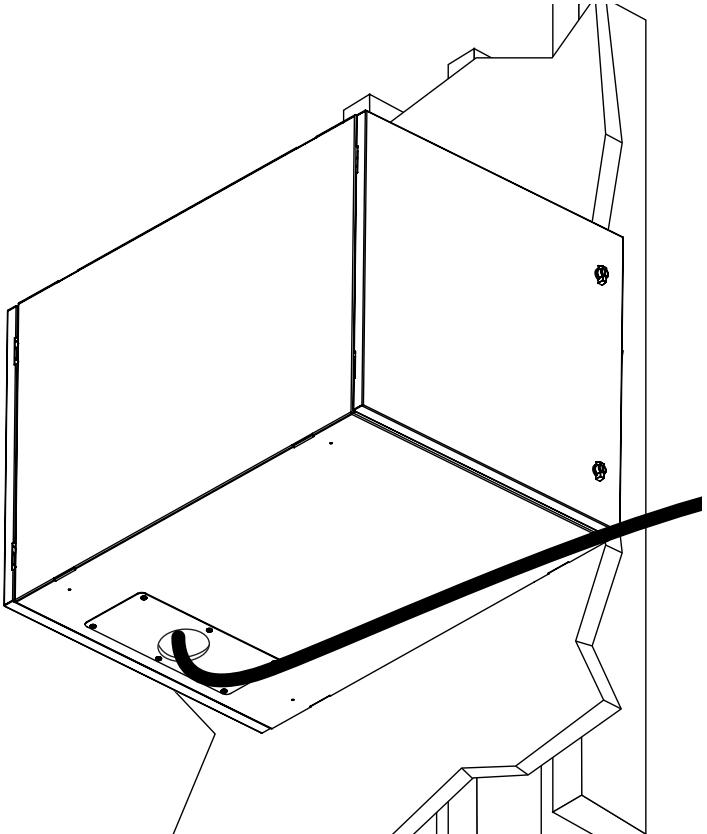
**Nota:** Para mantener una especificación NEMA, utilice accesorios sellados en los recortes al conectar a conductos.
