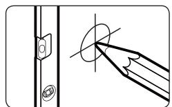
Marque la posición exacta de los orificios de instalación
