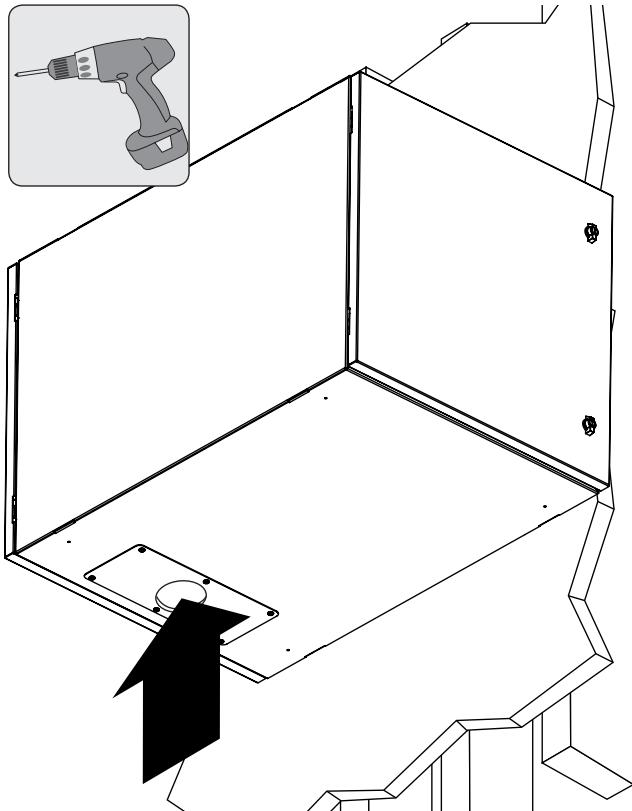
**Remarque :** Ce couvercle de conduit prend en charge un conduit de taille 2 maximum avec un trou de 2,5 po.
