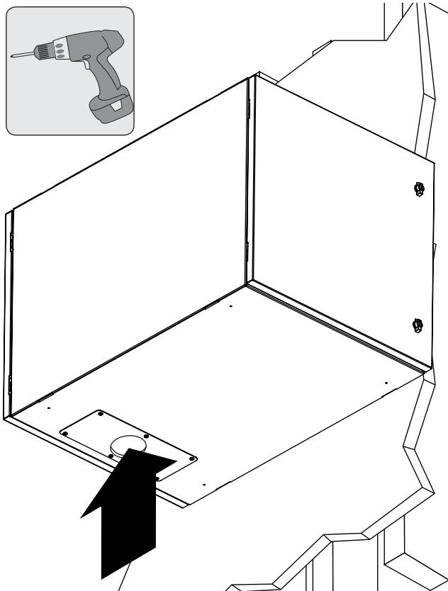
**Nota:** Esta tapa de conductos permite un tamaño comercial máximo de conductos 2 con orificio de 64 mm [2.5"].
