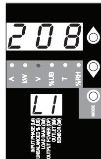
\* Remarque : Pour les modèles de 208V, les tensions affichées sont des tensions phase-à-phase (c.-à-d. l'affichage L1 indique le tension L1-L2). Pour les modèles de 400V, les tensions affichées sont des tensions phase-à-neutre (c.-à-d. l'affichage L1 indique le tension L1-N).
