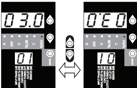
À tout moment, le fait d'appuyer sur les deux flèches de défilement de façon simultanée et de les maintenir pendant 3 secondes permet la rotation des affichages à 2 et 3 chiffres.
