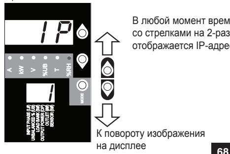
В любой момент времени при одновременном нажатии кнопок со стрелками на 2-разрядном дисплее в течение 1/2 секунды отображается IP-адрес устройства.
