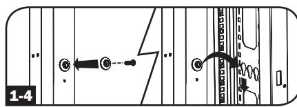
Nota: Cerciórese de insertar los dos botones en en cualquier orificio superior en **cada extremo** del PDU o en el orificio inferior en **cada extremo** del PDU.
