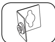
**Accesorio de Instalación PDUMVRotateBrkt:** Use estos soportes con perfil en V para instalar el PDU con sus tomacorrientes viendo a la parte posterior del rack.
