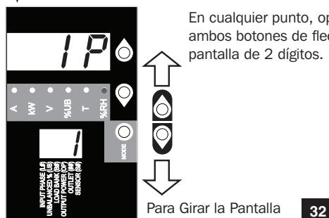
En cualquier punto, oprimir por 1/2 segundo simultáneamente ambos botones de flecha muestra la dirección IP de la unidad en la pantalla de 2 dígitos.
