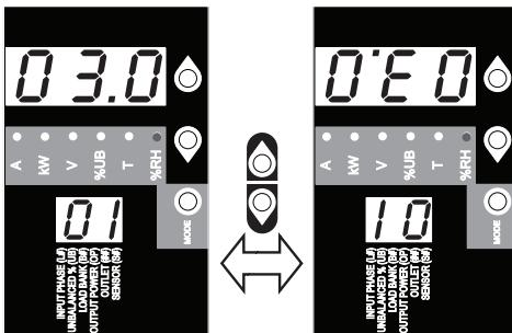
En cualquier punto, oprimir y sostener por 3 segundos simultáneamente ambos botones de flecha gira las pantallas de 2 dígitos y 3 dígitos.
