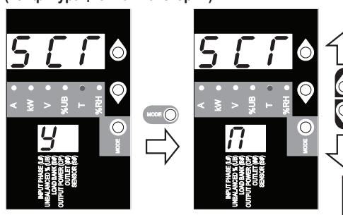
При включении функции автоматической прокрутки на дисплее с 4-секундным интервалом отображаются данные о входных фазах, дисбалансе нагрузок и группах нагрузок. Буква Y означает, что данная функция включена; буква N означает, что данная функция отключена. При нажатии любой кнопки происходит отключение функции автоматической прокрутки, что позволяет пользователю перемещаться между опциями меню. Если ни одна из кнопок не нажимается, то после прокрутки всех опций наступает 10-секундный перерыв.
