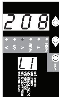
\* Nota: Para modelos de 208V, los voltajes mostrados son voltajes entre fases (v.g., la pantalla indicará voltaje entre L1-L2). Para modelos de 400V, los voltajes mostrados son voltajes entre fase y neutral (v.g., la pantalla de L1 indicará voltaje L1-N).
