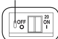
**Disjoncteur (Certains modèles) :** Il y a 3 bancs d'essai, chaque banc est protégé par un disjoncteur. Si la charge de l'équipement connecté dépasse la charge nominale maximale pour ceux bancs de la PDU, le disjoncteur se déclenchera. Débrancher la charge en excès et réinitialiser le disjoncteur.
