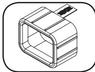
**Manguito de Clavija C20:** (Opcional) Use los manguitos plásticos C20 incluidos para asegurar las clavijas a los tomacorrientes. Acople el manguito a la clavija asegurándose que las pestañas de tiro permanezcan fuera de la clavija y que la sujeción sea segura. Para desenchufar correctamente el equipo, use las pestañas de tiro para retirar la clavija y el manguito del tomacorriente.
