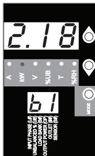
\* Remarque : Pour les modèles de 208V, les tensions affichées sont des tensions phase-à-phase (c.-à-d. l'affichage b1 indique le tension L1-L2). Pour les modèles de 400V, les tensions affichées sont des tensions phase-à-neutre (c.-à-d. l'affichage b1 indique le tension L1-N).
