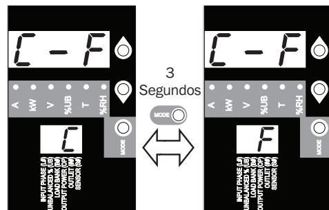
Oprima el botón de modo (Mode) para cambiar entre opciones y datos dentro de un menú. Una presión momentánea de los botones de flecha cambia entre menús. Una presión prolongada salta entre categorías de mediciones. El patrón de desplazamiento en la pantalla se detalla a continuación.
