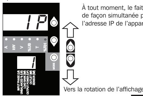
À tout moment, le fait d'appuyer sur les deux flèches de défilement de façon simultanée pendant 1/2 seconde permet d'afficher l'adresse IP de l'appareil sur l'affichage à 2 chiffres.
