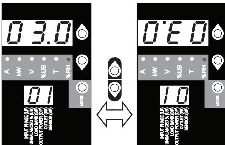
В любой момент времени при одновременном нажатии кнопок со стрелками и их удержании в течение 3 секунд производится поворот изображений на 2-разрядном и 3-разрядном дисплеях.
