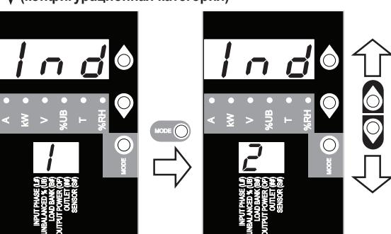
Для переключения между опциями удерживайте кнопку выбора режима (MODE) нажатой в течение 3 секунд. Цифра, отображаемая на 2-разрядном дисплее, означает выбранный тип маркировки: 1=стандартная, 2=альтернативная
