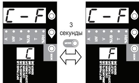
Для переключения между опциями удерживайте кнопку выбора режима (MODE) нажатой в течение 3 секунд. Буква, отображаемая на 2-разрядном дисплее, обозначает выбранную единицу измерения (С – Цельсий, F – Фаренгейт).
