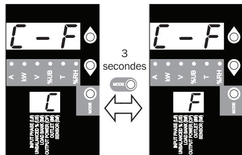
Maintenir le bouton Mode pendant 3 secondes pour passer d'une option à une autre. La lettre sur l'affichage à 2 chiffres indique l'unité sélectionnée, C pour Celsius et F pour Fahrenheit
