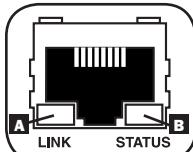
**Puerto Ethernet:** Use este enchufe RJ-45 para conectar el PDU a la red con un cable patch estándar de Ethernet. El LED de Liga **A** y el LED de Estado **B** indican algunas condiciones de operación, como se muestra en la siguiente tabla. Este puerto no es compatible con aplicaciones de PoE (Energía sobre la Ethernet).
