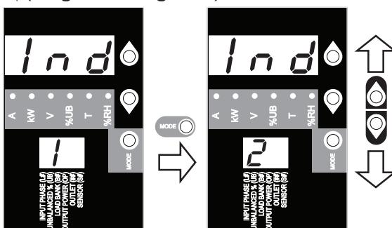
Maintenir le bouton Mode pendant 3 secondes pour passer d'une option à une autre. Le nombre dans l'affichage à 2 chiffres indique le schéma sélectionné. 1=standard, 2=alternatif
