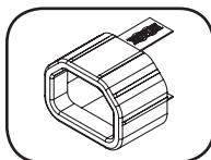
**Manguito de Clavija C14:** (Opcional) Use los manguitos plásticos C14 incluidos para asegurar las clavijas a los tomacorrientes. Acople el manguito a la clavija asegurándose que las pestañas de tiro permanezcan fuera de la clavija y que la sujeción sea segura. Para desenchufar correctamente el equipo, use las pestañas de tiro para retirar la clavija y el manguito del tomacorriente.
