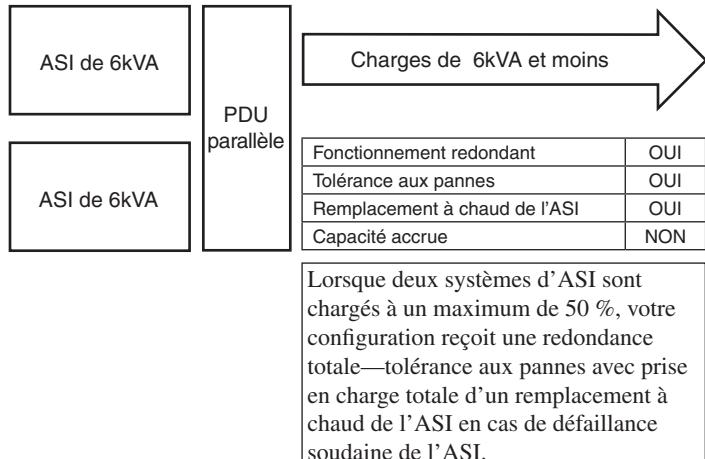
Pour garantir une tolérance aux pannes, chargez les deux systèmes d'ASI parallèles à un maximum de 50 % des indices combinés pour les deux systèmes d'ASI. Par exemple, si vous possédez deux systèmes d'ASI de 6kVA, vous bénéficieriez d'un fonctionnement tolérant aux pannes si le niveau de charge reste à 6kVA ou moins.
