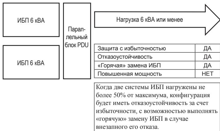
Чтобы обеспечить отказоустойчивость, нагрузка на две параллельные системы ИБП не должна превышать 50% совокупной мощности этих ИБП. Например, если имеется две системы ИБП 6 кВА, безотказная работа будет поддерживаться при условии, что нагрузка будет оставаться на уровне 6 кВА или менее.
