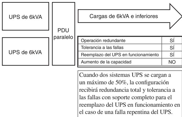
Para garantizar la tolerancia a las fallas, cargue los dos sistemas UPS paralelos a un máximo de 50% de los valores combinados para ambos sistemas UPS. Por ejemplo, si posee dos sistemas UPS de 6kVA, contará con operación tolerante a las fallas si el nivel de carga permanece en 6kVA o inferior.
