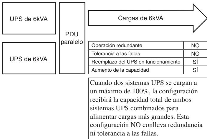
Puede utilizar esta configuración para aumentar la capacidad de potencia del UPS a 12kVA. En esta configuración, NO se dispone de tolerancia a las fallas.
