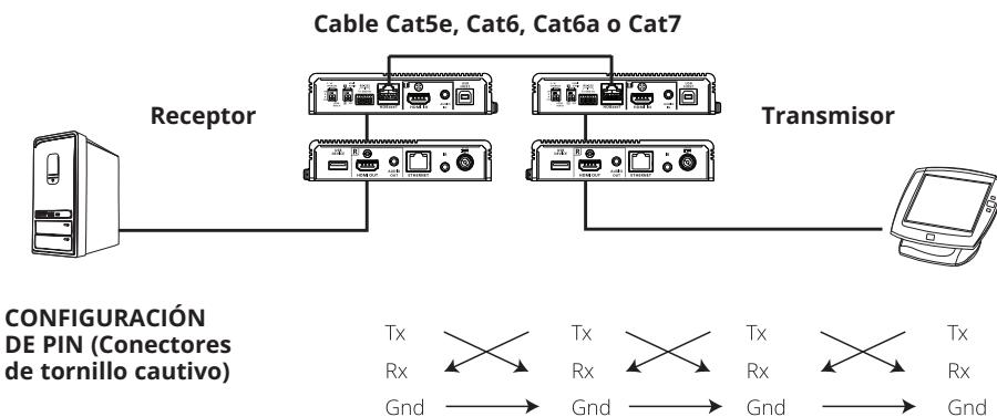
El concepto general aquí es que se puede transmitir una señal RS-232 (Tx) al extremo receptor (Rx) de una unidad. La señal recibida puede luego transmitirse (Tx) al extremo receptor (Rx) de otra unidad. Las señales RS-232 pueden transmitirse en sentido contrario.
