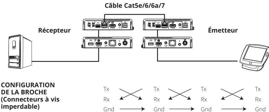
Le concept général ici est qu'un signal RS-232 peut être transmis (Tx) à l'extrême réceptrice (Rx) d'un appareil. Le signal reçu peut alors être transmis (Tx) à l'extrême réceptrice (Rx) d'un autre appareil. Les signaux RS-232 peuvent être transmis dans l'autre sens.
